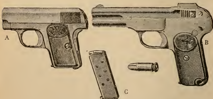
Fig. 25. — Pistolet automatique Browning. — A, petit modèle, calibre 6 m ,35. — B, grand modèle, calibre 7 m ,65. — C, chargeur.
