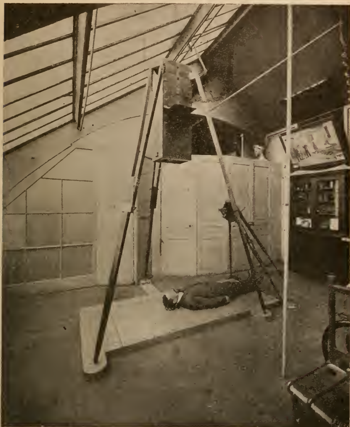
Fig. 120. — Grand appareil de Bertillon pour la photographie de cadavres à la réduction de 1 pour 2,5.
